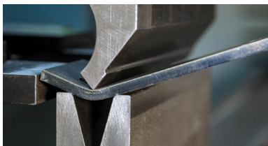
3. ábra – Egy fém munkadarab rugalmatlan alakváltozása megmunkálása közben
