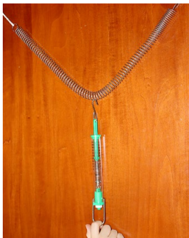
4. ábra – Eredő erő meghatározása dinamométerrel
