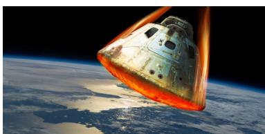
3. ábra – A légkörbe visszatérő űrkapszula mozgási energiája hőenergiává alakul át.
