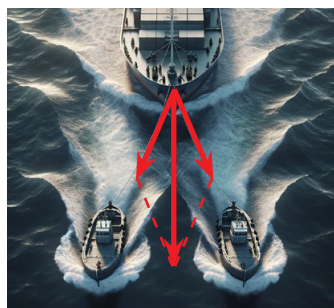
5. ábra – A vontatókábeleken fellépő két erő határozza meg az uszály haladási irányát.
