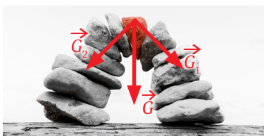
1. ábra – Az árkád stabilitását a zárókő biztosítja, melynek súlya a tartóoszlopokhoz közvetítődik.
