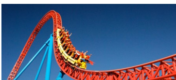
3. ábra – Lefelé jövet a vonat helyzeti energiája csökken, mozgási energiája nő. Felfelé menet mindez fordítva történik.
