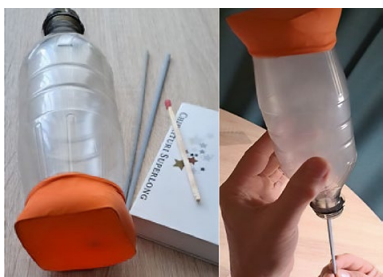
3. ábra – Hangterjedés vizsgálatára szolgáló kísérleti eszköz elkészítése (egyszerű anyagokból).
