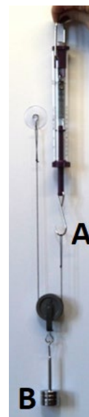
8. ábra – A mozgócsiga lefelé és felfelé is elmozdulhat.
