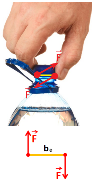
8. ábra – A dugó csavarásához alkalmazott erőpár
