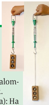
2. ábra – A súlyerő és a feszítőerő mérése dinamométerrel
