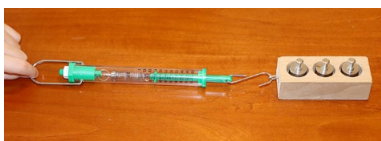
3. ábra – A súrlódási erő meghatározása dinamométerrel
